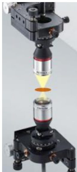
图 2-11 测头安装示意图
