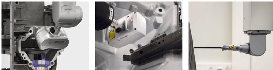
图 5-15 几种测量传感器的工作位置
