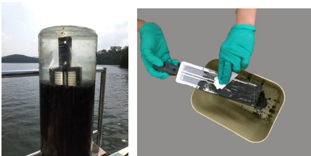
图 4.3 HR-Peeper 装置的投放与回收
