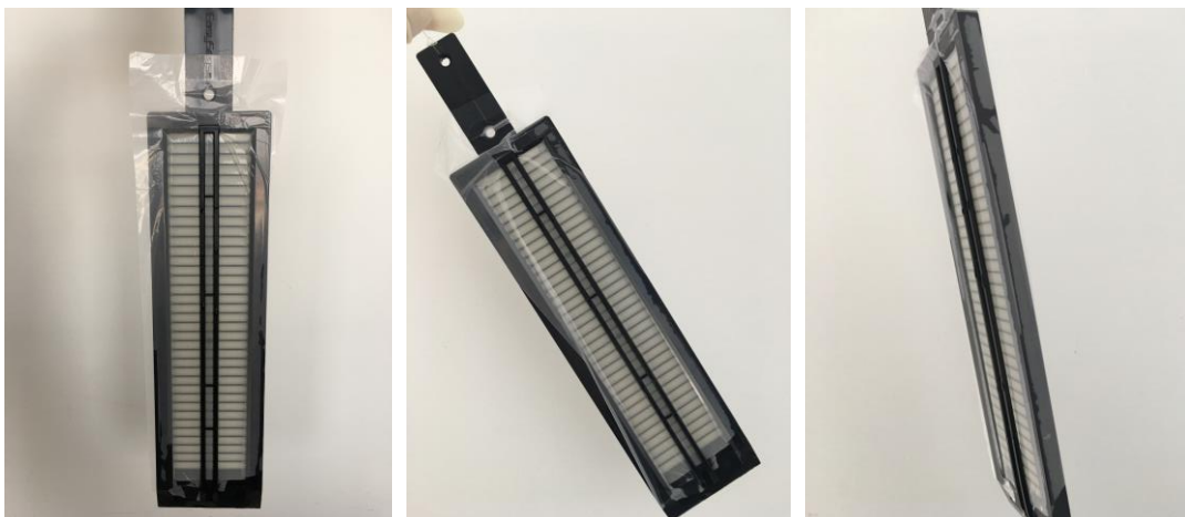
图 4.2 HR-Peeper 组装后实物图
