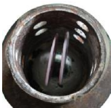
图 11 钢铃罩住蜡模时的情形
