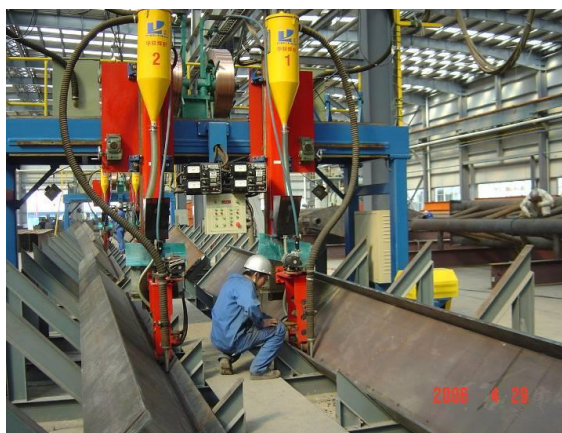
焊接 H 型钢生产线配备埋弧自动焊
