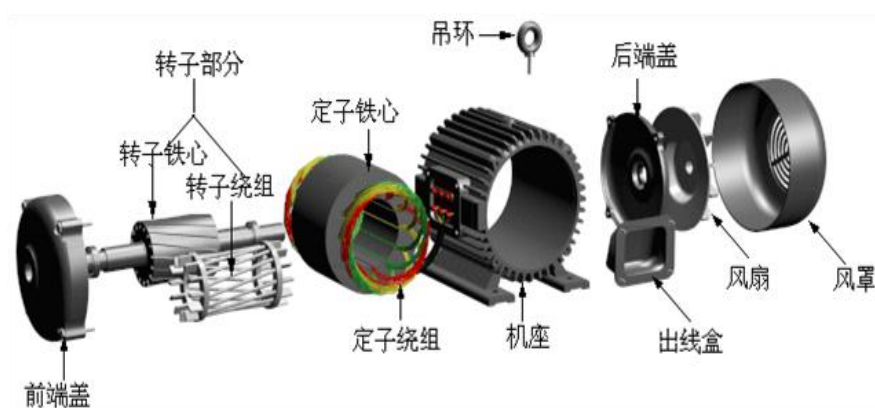
鼠笼型异步电动机主要部件拆分图
