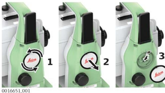
将 SIM 卡插入带有标志的盖子的后侧插槽，几乎位于外壳中心。
