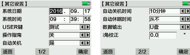
(1)系统日期：显示和设置系统的日期。一旦输入，仪器就将输入的日期存入系统。日期格式：年.月.日
