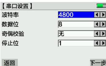
设置好后点击“下一步”进入【串口测量】界面，在本界面下进行串口测量，测量协议请联系仪器生产商。
