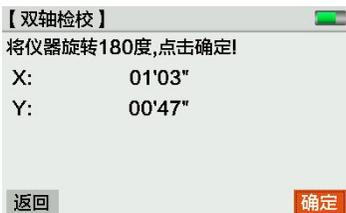
3 确认校正改正值是否在校正范围内，如果 X 值和 Y 值均在校正范围内，按【确定】键对改正值进行更新，反之退出校正操作，并与仪器销售商进行联系。
