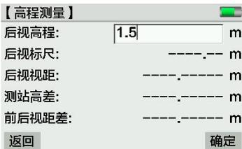
按压【MEAS】按钮启动测量，测量完成后点击“确定”查看高程测量结果。
