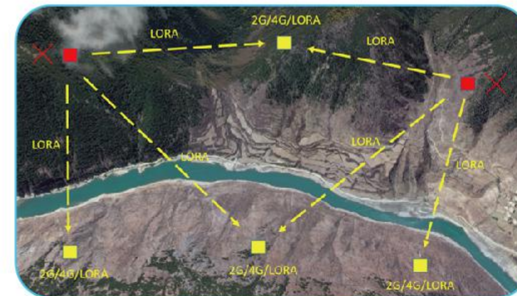
（2）若2G不通，则通过LoRa寻找距传感器最近的A型2G的RTU上传数据；
