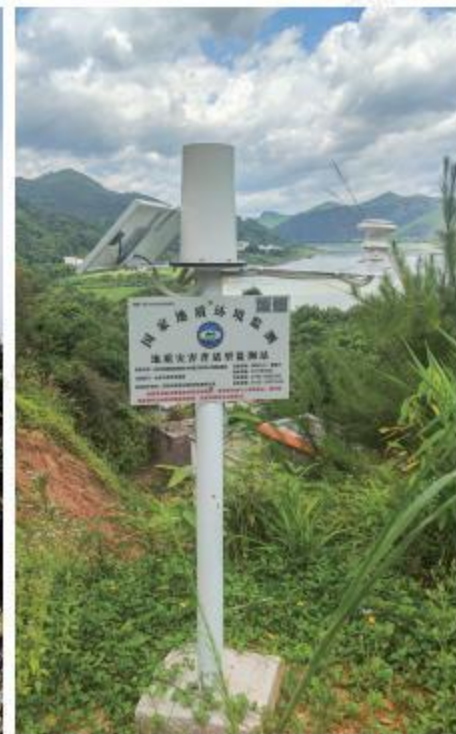
广东倾角加速度计+雨量计安装
