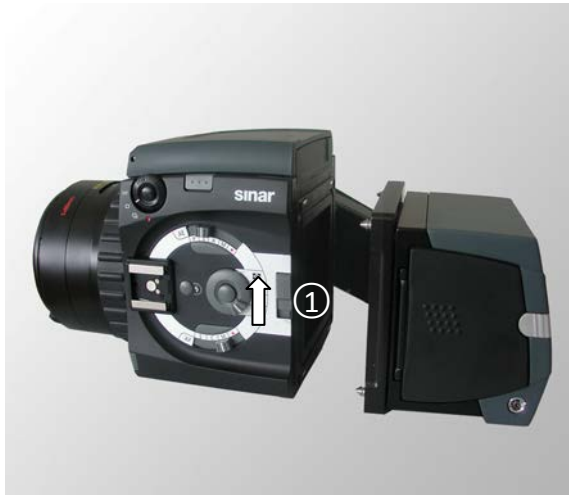
Fig. 5 / 15连接数码后背
