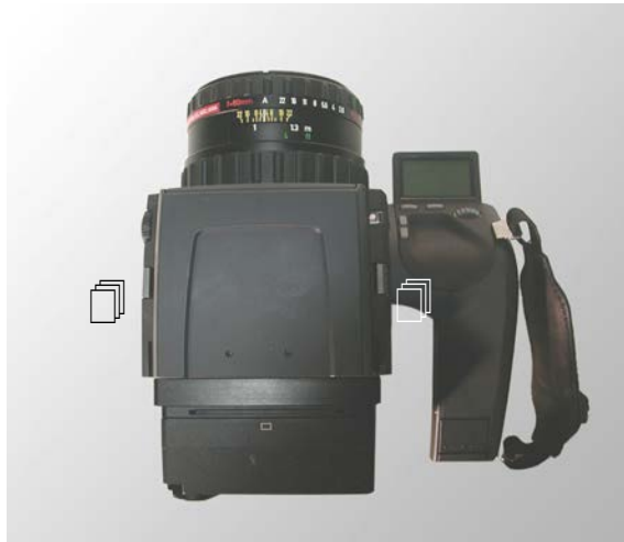
Fig. 5 / 3 拆除腰平取景器
