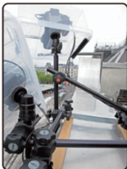
它们在恶劣天气装上塑料盒保护的摄像机，长期监测和记录施工现场，安装在超级球型云台M-1和使用FOBA的组合支架，并且固定在房屋的边缘上。
