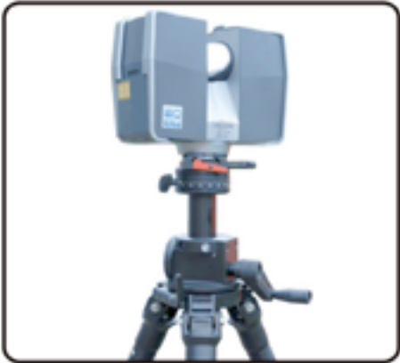
激光扫描仪安装在一个坚固的FOBA三角架上, 使用ASTIU全景360转盘, BALSO超级球型云台装板和BALPU快装板。
