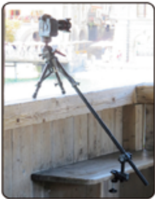
例图：使用了全景平台 (BALTO)，并将小型脚架 (ASN10) 用组合支架以及螺丝夹 (COGAE) 固定在木板凳上，悬空的全景拍摄而不失平衡
