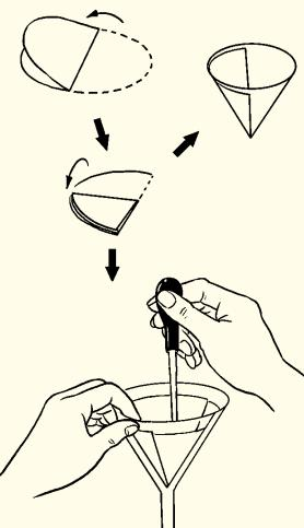
折滤纸：取一圆形滤纸，对折两次，打开成圆锥形
