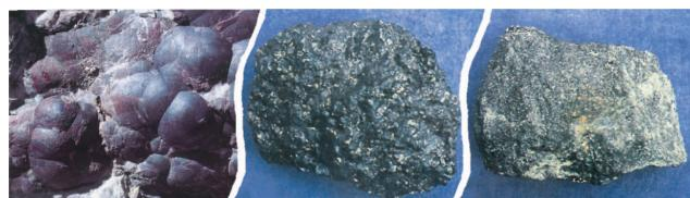
赤铁矿( $\text{Fe}_2\text{O}_3$ ) 钛铁矿( $\text{FeTiO}_3$ ) 磁铁矿( $\text{Fe}_3\text{O}_4$ )
