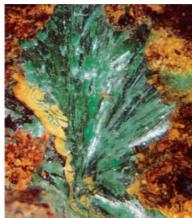
孔雀石 [ $\text{Cu}_2(\text{OH})_2\text{CO}_3$ ]
