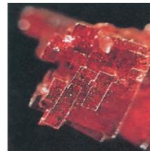
赤铜矿( $\text{Cu}_2\text{O}$ )
