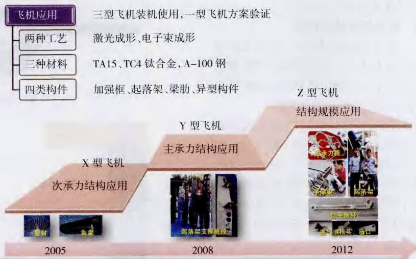
图8 增材技术在飞机结构上应用的3个重要阶段
