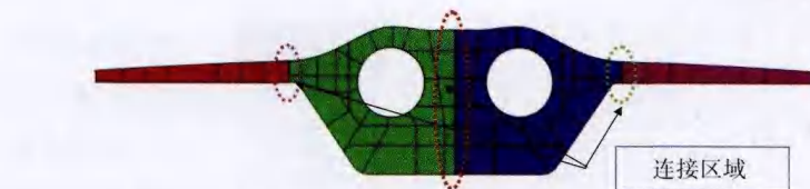
图5 框梁一体化整体结构
