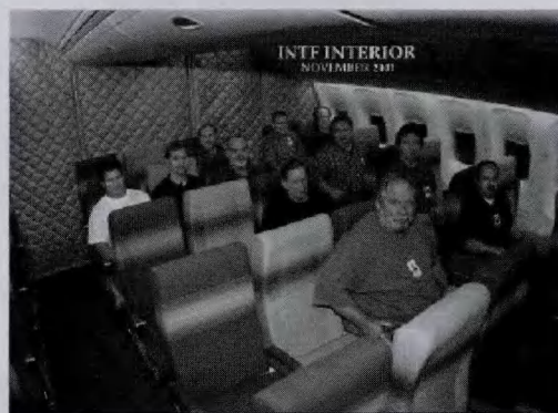
图 11 机身舱段吸声性能声学试验
