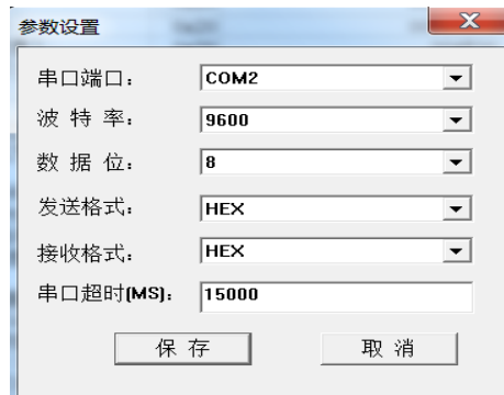
图 12 串口调试软件的设置
