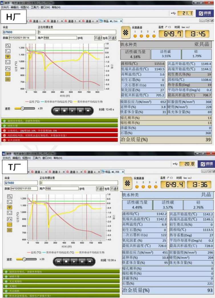
图 6 QT600 与 FCD450 两种铁水浇注铜孕育剂样杯的热分析曲线对比
