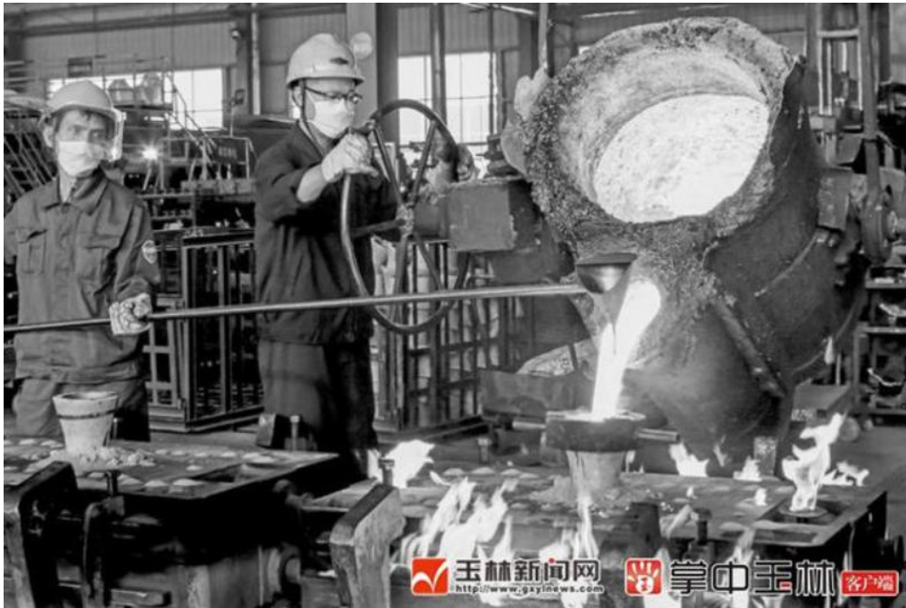
员工在进行曲轴浇注作业
