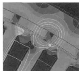
图 4 普通近极槽永磁电机齿顶漏磁
