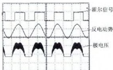
图 6 霍尔信号、反电动势、相电压波形截图
