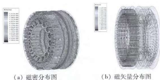
图5 无刷旋转变压器磁密分布图和磁矢量分布图
