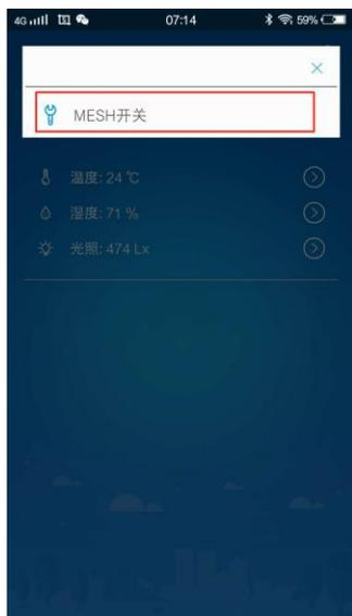
注：mesh 开启后，设备断电重新上电，设备会有几分钟处于组网状态。用户需要等待几分钟后才可以使用的。
