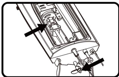
② 先关闭电源并拔出电池，然后一只手按紧船内的转轴，另一只手用扳手拆解
