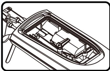
② 将电池放入电池仓中，旋好电池固定钮，把电源线插好
