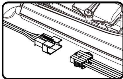
③ 拔掉船体电源连接线，取出电池
