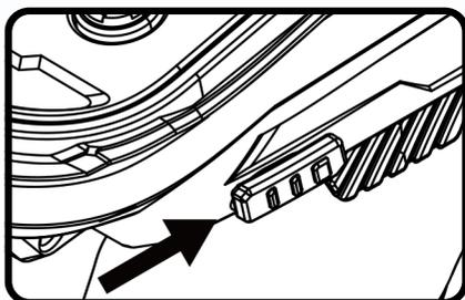
④ 将遥控器装入电池后打开遥控器开关
