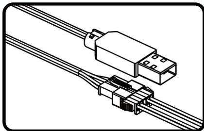
④ 把电池接口连接USB充电线，接入电源即可进行充电，USB端口亮红灯表示正在充电，完成充电后红灯熄灭
