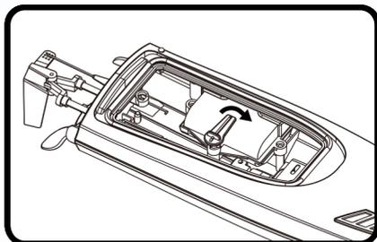
② 顺时针90度转动电池舱的电池固定旋钮
