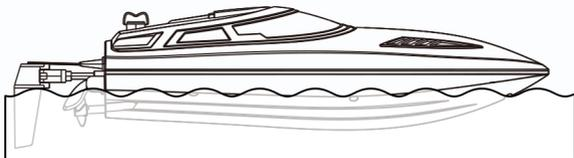
拨动开关键，并将船放入水中，对上频后遥控器绿灯常亮，并伴随有的“滴”一声，即可玩耍
