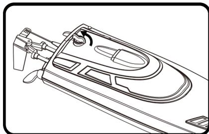
① 90度转动船舱盖旋钮，取下舱盖
