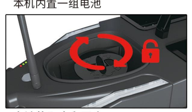
◆电池的取出和固定 顺时针旋转即可打开并取出电池,将固 定架按压到位后逆时针旋转即可固定
