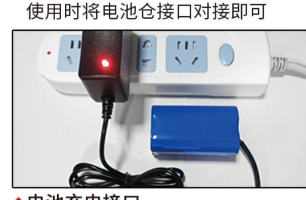
◆电池充电接口 把电池接上充电器即可充电红灯: 充电中 绿灯: 充电完成
