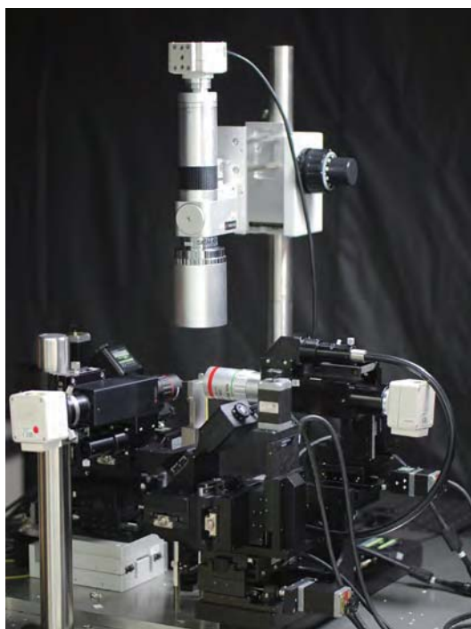
观察系统由自动运动控制平台和观察组件构成。
