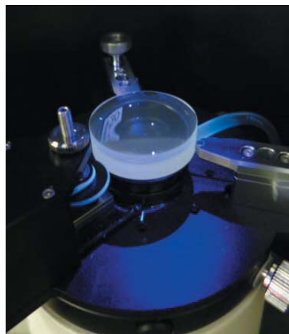
使用紫外固化胶和对中望远镜的胶结工序
