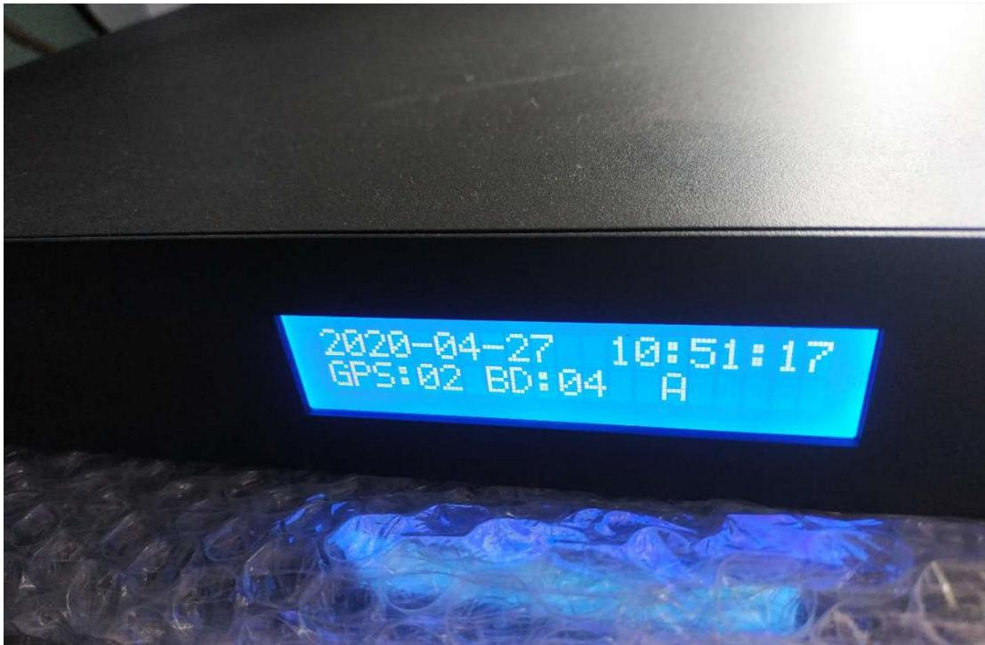
有些客户在测试完成后，断开天线，发现面板上的字母还是 A。这是正常现象由于本机在第一次接收到正确的基准时间后，本机会自动保持原有的时间继续走时，因此液晶显示界面还是“A”，表示目前本机输出的时间依然有效，还是可以使用的。
