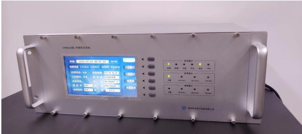
变电站中，GPS 对时系统是非常重要的，一般情况下对时系统需要给微机保护装置、后台监控系统等设备进行对时。使得整个站的设备时间一致。在变电站中给设备的对时方式有 B 码对时、串口对时、脉冲对时。但在多数情况下使用的是 B 码对时。
