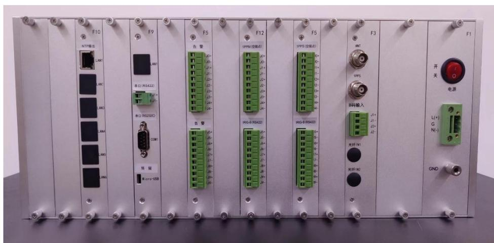
扩展单元与主时钟、各种智能装置之间因为位置的不同需要使用到不同的介质，如果确定为同一屏柜需要采用电缆，而在多个小室变电站中的主时钟和扩展装置间使用光纤，那么连接对时各种智能装置通常会采用双绞线。比如变电站常用我司自主生产的 SYN4505A 型 GPS 时间同步装置，SYN4505A 型时钟同步系统内装高精度恒温晶振（可选锁相模块或者铷原子钟），接收 GPS（全球定位系统）、北斗二代卫星信号和远地传送来的 IRIG-B 码信号获得时间信息，可根据客户对同步时钟系统的不同需求，选择相应的功能的板卡，同步产生 IRIG-B 码信号、秒脉冲、分脉冲、时脉冲、串口时间信息信号、网络授时接口（PTP, NTP/SNTP 等）及各种报警信息，系统对各种配置
