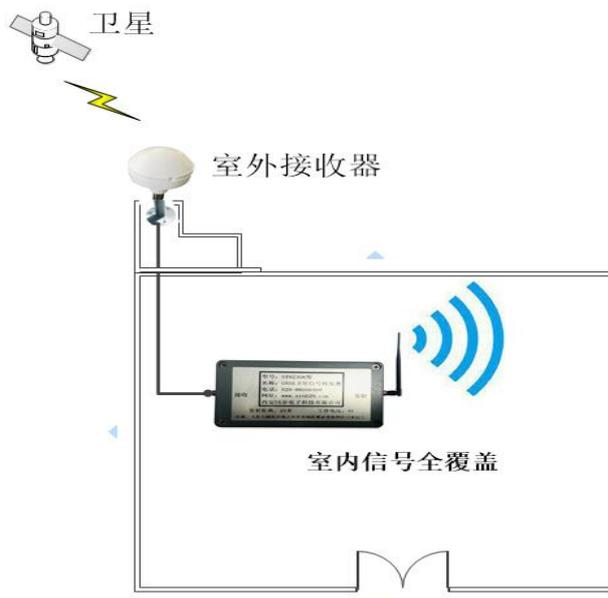
SYN2308 型 GNSS 卫星信号转发器主要是由卫星接收天线、低损耗射频电缆、转发器主机三部分组成。
