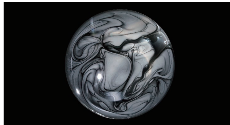
部分经由微流化工艺处理的石墨烯导电墨水。图片来源：James Macleod/ 剑桥大学工程系
